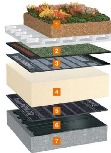
Abbildung 2.4: Beispiel für ein begrüntes Flachdach mit Attika (links) und schematischer Aufbau mit Wärmedämmung (rechts)
