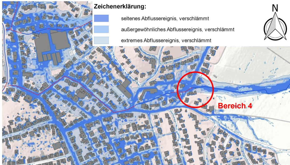
**Abbildung 15: Überflutungsausdehnung aus der SRGK im Maßnahmenbereich 4**
