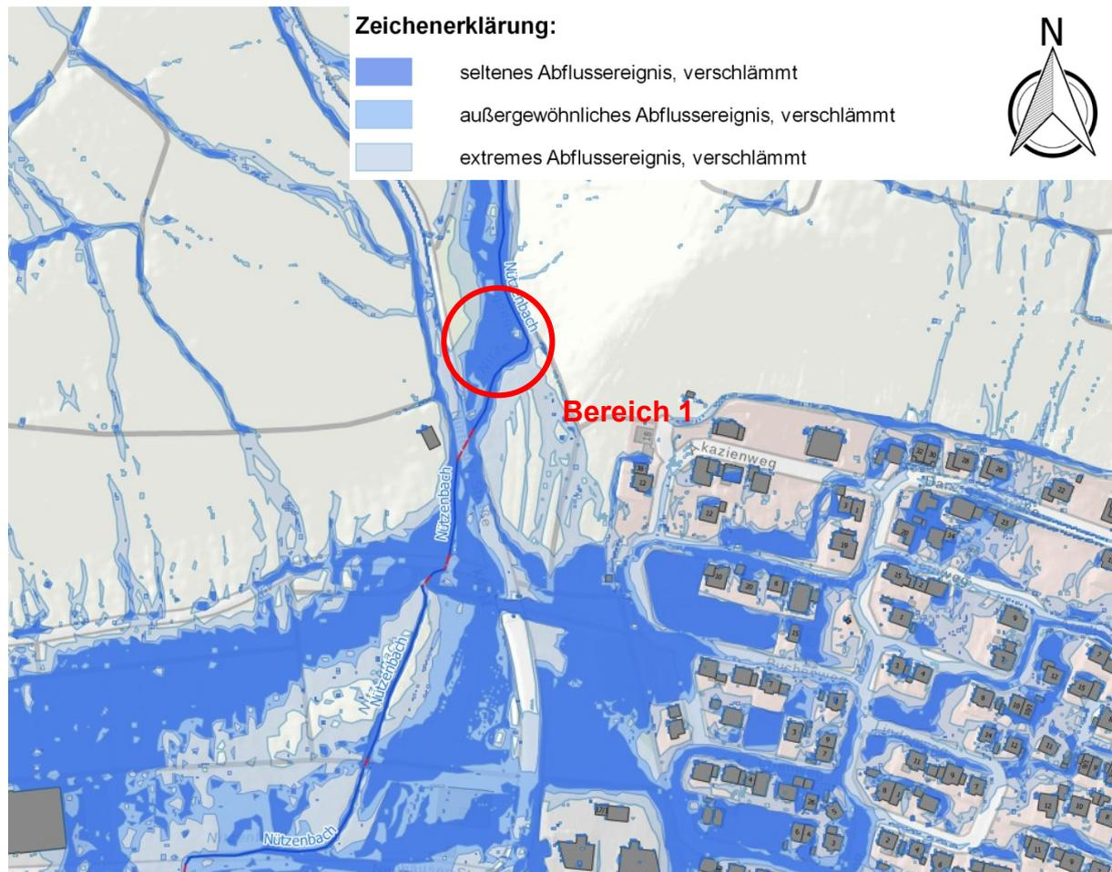
**Abbildung 3: Überflutungsausdehnung aus der SRGK im Maßnahmenbereich 1**
