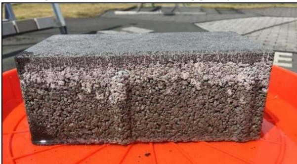
Da die Deckschicht undurchlässig ist, fallen Probleme von komplett haufwerksporigen Betonsteinen wie eine größere Frostempfindlichkeit, geringere Druckfestigkeit, Ausblühungserscheinungen durch aufsteigendes Wasser und Algenbildung durch mögliche hohe Feuchtigkeit an der Oberfläche weg. Außerdem lassen sich die Oberflächen vielfältiger gestalten, da die Steine
